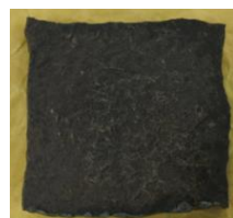
腐蚀钢板 (样品2)
